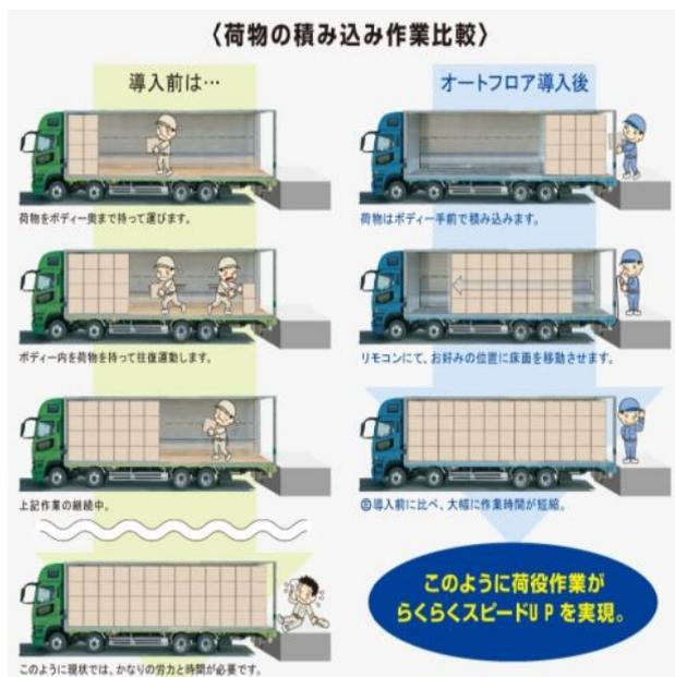
導入前は荷台の一番先頭まで荷物を持って運んでいましたが、オートフロア導入後は荷台の中に入ることなく手前で荷物の積み降ろしが行えます。主にホームに接車しての積み込み・荷降ろし作業で効果を発揮します。
