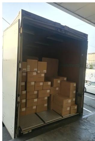
『オートフロア』は軽量設計で、機械本体の高さはフロント部 13 センチ、リア部 9 センチと超薄型設計により荷台面積のロス、積載量の減トンなどの心配もありませんのでご安心ください。
